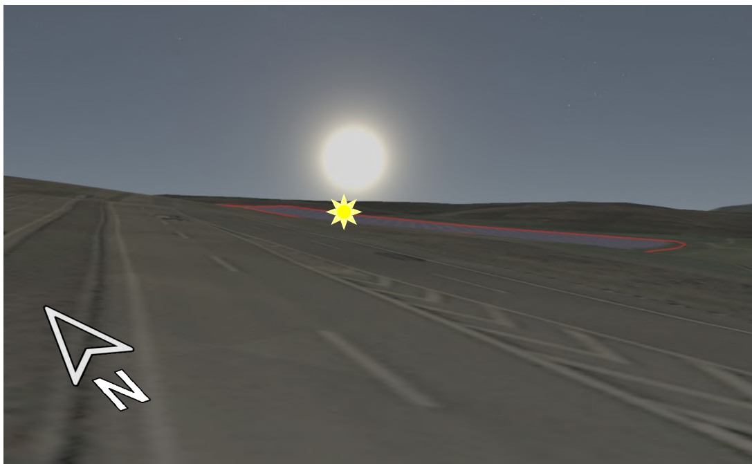
Abbildung 15: Beispielhafte Sicht eines Fahrzeugführers von der A 7 auf die PVA am 21.06. um 06:00 (Sommerzeit). Die Reflexion an den PV-Modulen wird durch ein gelbes Sonnensymbol dargestellt. Das PVA-Gelände ist rot umrandet. - Quelle: Google Earth Pro (modifiziert)
